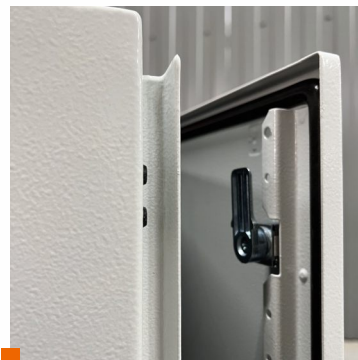
Скошенный желоб Предотвращает попадание влаги в корпус
